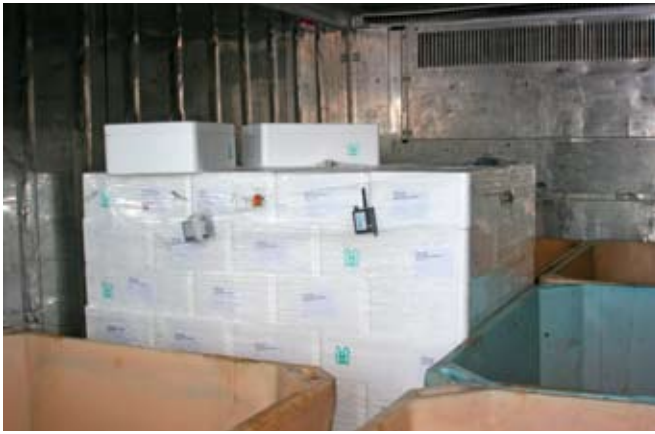
Mynd 3. Tilraunasending af þorskhökkum í kældum flutningagámi. Tæknibúnaði með hitaskynjurum og þráðlausum sendibúnaði var komið fyrir bæði utan á brettið og innan í kössunum til að fylgjast með bæði umhverfis- og vöruhita.
